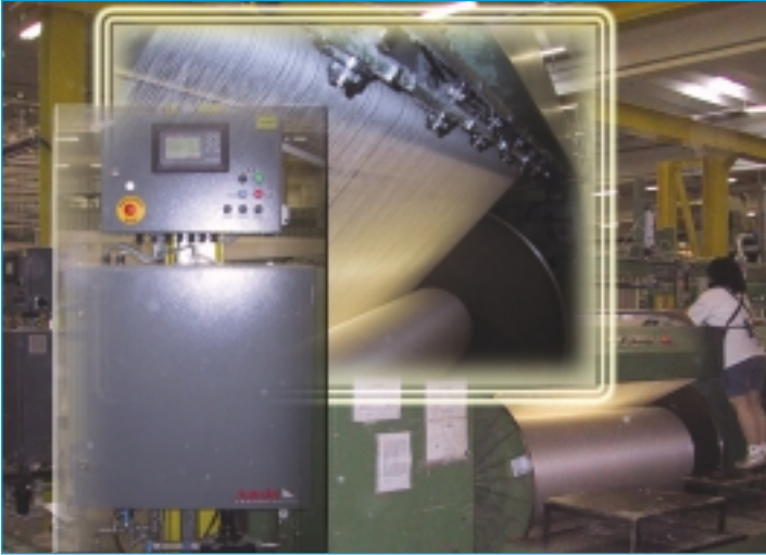
Het regelsysteem past automatisch de spuihoek aan, afhankelijk van de afstand tot het garen. De spuihoeveelheid wordt ook aangepast aan de snelheid van het garen.
